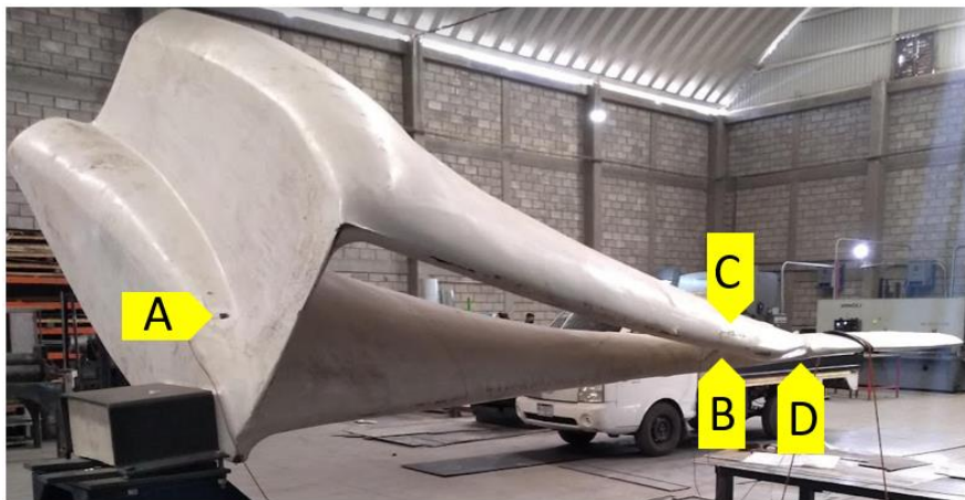
Imagen 10.- Galgas instaladas en el álabe para las pruebas a Flapwise.
